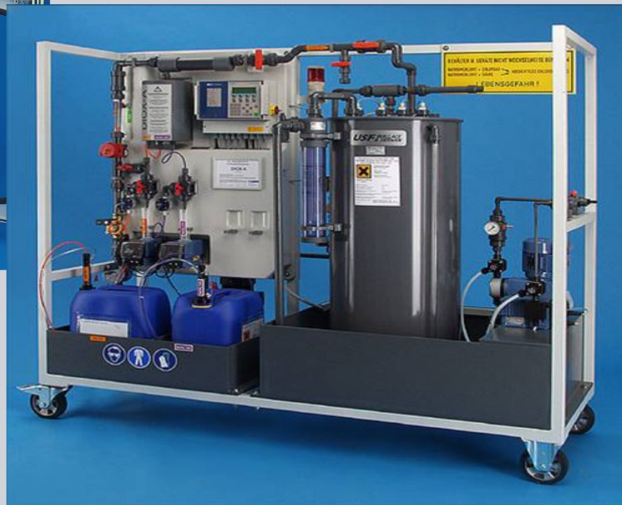
DIOX-A 250 Móvil con tanque de almacenamiento de ClO 2
